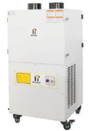
DS系列是顶吸式工业集尘器，吸尘口在主机上方，主要是对于配套设备从顶部连接管道，可以最大程度的减少设备的占地面积和软管的绕程。
