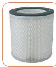
滤筒式过滤器, 进口聚酯纤维基材, PTFE覆膜处理, 最高过滤精度0.1μm。可选防油防水、阻燃、防静电、唐纳森等材质。
