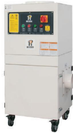
DE系列是紧凑型带自动清灰功能的工业集尘器，外形美观，滤筒式过滤，占地面积小，一键式电动振尘清灰，对于粉尘量较大的场合特别适用。
